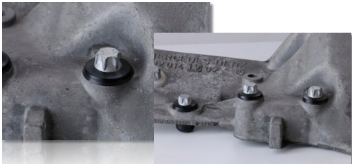
Spezielle Schutzkappe am Getriebegehäuse aus Magnesium AZ 93 HP
