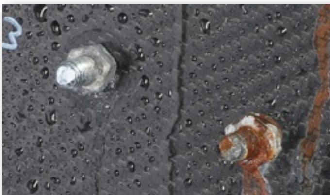
Probe 3 Mutter verzinkt M6 links oben geschützt durch Schutzkappe rechts unten ungeschützt
